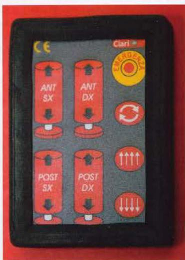
Zoom sur la télécommande sans fil qui permet de tout contrôler à distance en observant les manœuvres. Grâce à elle, M. Papin a pu aussi effectuer le processus de purge hydraulique en sortant 2 fois à fond les vérins puis en vérifiant que le réservoir d'huile hydraulique reste rempli à 75%. Notez aussi que l'on peut sortir ou rentrer les 2 vérins avant ou arrière d'un seul appui sur une touche pour une meilleure vidange ou monter à bord d'un ferry par exemple...
