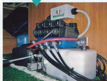
Ici, on distingue clairement les deux tubes des circuits hydrauliques typiques des vérins à double effet, le point fort de ce système. En haut, arrive la pression nécessaire à l'effort et le débit piloté par l'électrovanne pour la vitesse de sortie, en levage donc. Idem pour le tube inférieur dans le sens de la rétraction. Notez les capteurs inférieurs de position ou microswitchs qui renseignent le calculateur et la moto-pompe sur l'état de repos des 4 vérins...
