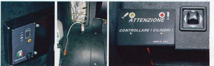
Gros plan sur le boîtier commande avant déporté avec son option de témoin sonore et lumineux du fonctionnement des vérins. Un basculeur permet de mettre tout le système en route via une nappe électrique (en gris) sans devoir aller jusqu'à l'unité centrale fixée dans la soute arrière. Ensuite, le conducteur peut effectuer la mise à niveau via la télécommande
