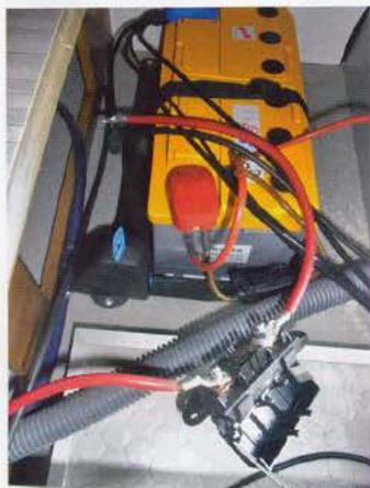
Ici dans le bac de la batterie de cellule, le plus de l'alimentation de l'électro-pompe est protégée des court-circuits par un (méga!) fusible de 150 A tandis qu'une valeur de 10 A suffira pour l'unité centrale de commande en soute. Notez la forte section du câble rouge du plus de la moto-pompe et la gaine grise qui protège la nappe de liaison de l'unité de commande arrière et avant...
