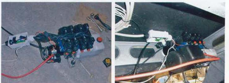
Zoom sur le câblage des électrovannes et de la moto-pompe avant son montage sur la platine en L sous le châssis. Pour plus de facilité, M. Papin a numéroté les 8 sorties des électrovannes et disposé un boîtier étanche regroupant toute la connectique de leurs commandes en provenance de l'unité centrale.
