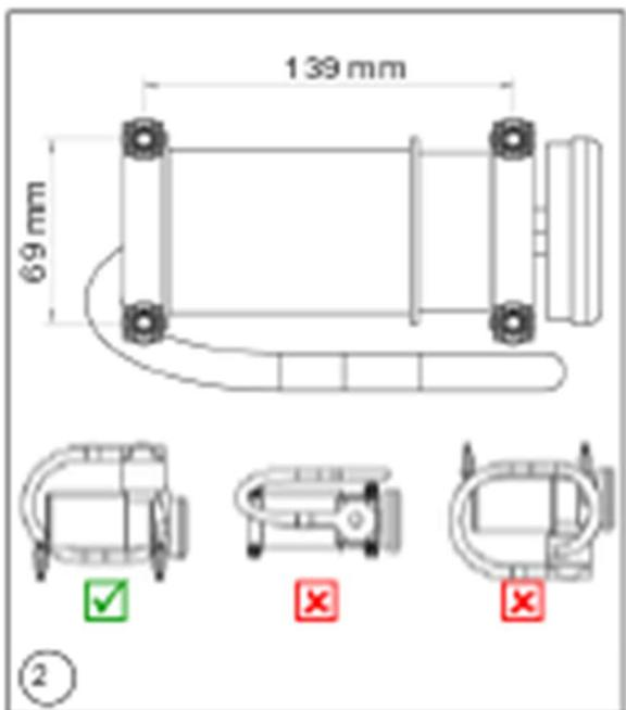
Déterminez la position du compresseur. Seul le positionnement vertical est autorisé. Percez quatre trous de  $\varnothing 5,5$  mm sur un rectangle de 139 x 69 mm.
