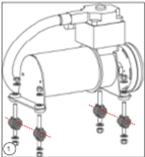
Montez les tampons annulaires dans les tiges de fixation du compresseur. Positionnez-les dans la direction de la ligne pointillée rouge comme indiqué sur le schéma.
