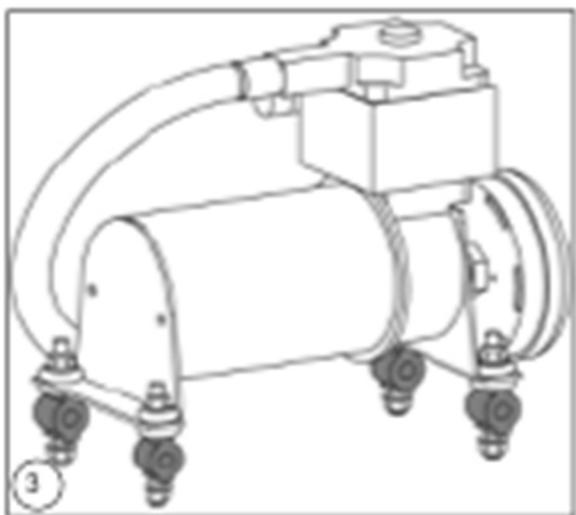
Fixez le compresseur et raccordez le câblage et les tuyaux d'air au compresseur.
