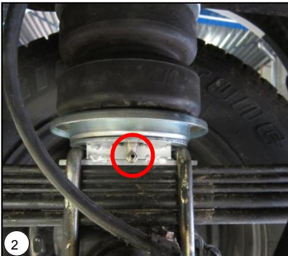
**NL** Plaats de luchtbalg onder de veerstroppen en zet deze weer vast (aanhaalmoment: zie werkplaats-handboek). Zorg ervoor dat de luchtaansluiting naar binnen is gericht.
