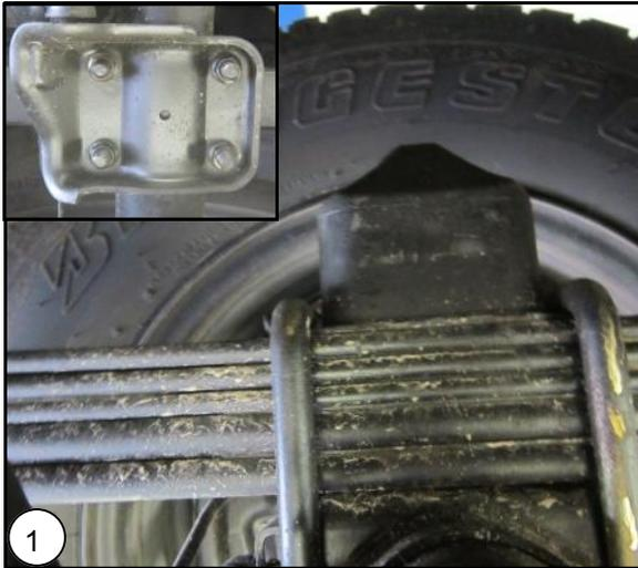
**NL** Draai de vier moeren van de veerstroppen een stukje los zodat de originele buffer verwijderd kan worden. Doe dit niet aan beide kanten tegelijk.
