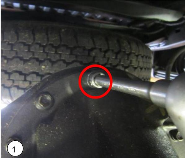
**NL** Draai de aangegeven **moer** van het differentieel los en monteer de magneetsteun verticaal op het differentieel. Zet de moer weer vast.
