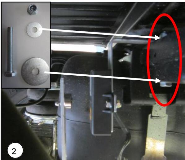
**NL** Monteer de sensorsteun aan bovenzijde van de chassis-balk. Gebruik aan de onderzijde de bijgeleverde carrosseriering (M10x50). Zet de bout vast.
