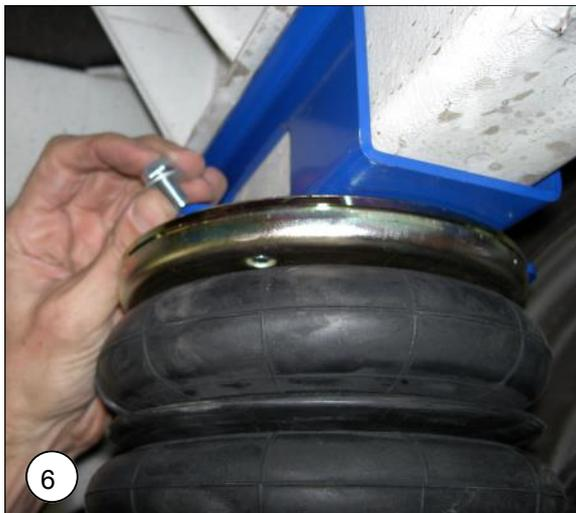
**NL** Bevestig de balg aan de bovenplaat met de M8 veerringen en M8 bouten.
