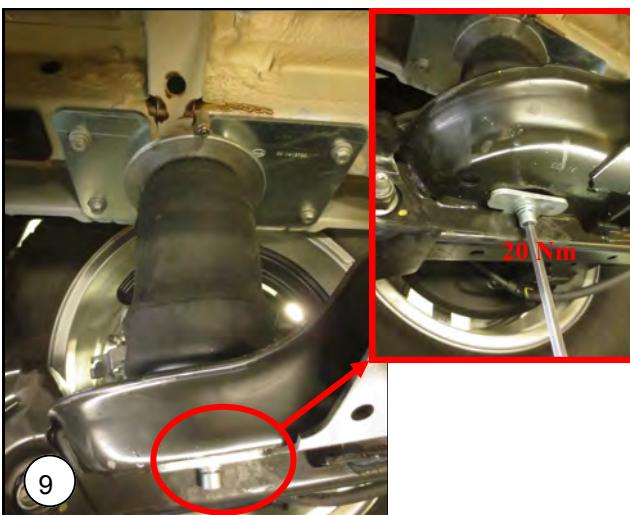
**NL** Zet de onderzijde van de luchtbalg vast met meegeleverd montage materiaal. Zet de centrale bout vast met een aanhaalmoment van 20-Nm.
