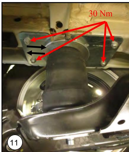
**NL** Lijn de balgen met de bovenplaat zo uit dat ze recht boven de onderschotels staan en zet de bovenplaten vast met **30 Nm**.
