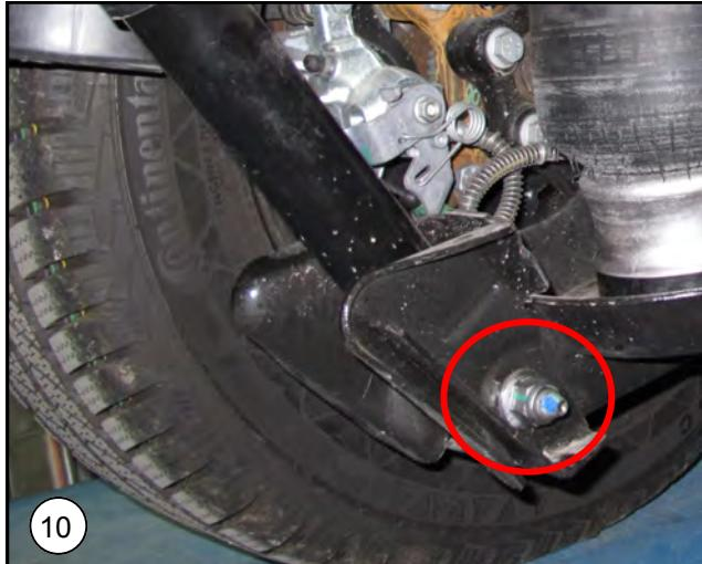
**NL** Zet de schokdempers vast met de originele bouten. Laat de auto nog **NIET** helemaal zakken. Hierdoor kan onherstelbare schade aan de luchtbalgen ontstaan.
