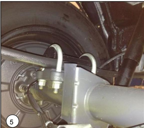
**NL** De onderplaat moet geplaatst worden op de bevestiging van de stabilisatiestang. Als er tape op zit, verwijder deze dan.
