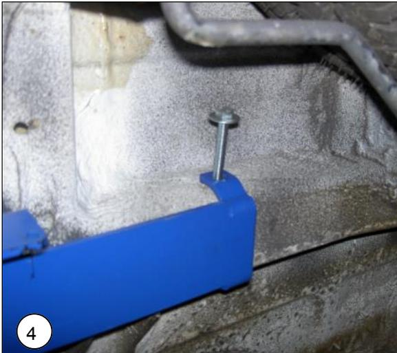
**NL** Zet de achterzijde van de bovenplaat vast met de M10x120 bout. **Uitvoeringen met stabilisatorstang: Gebruik de originele bout.**
