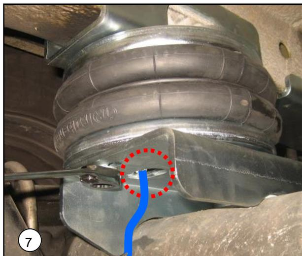
**NL** Plaats de luchtbalg tussen de platen en voer de lucht slang door het grote gat in de onderplaat. Sluit vervolgens de luchtslang aan op de balg.
