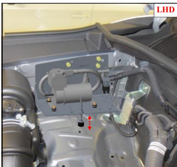
**NL** **Alleen Left Hand Drive:** Monteer de Compressorsteun met compressor zoals aangegeven op de afbeelding. Gebruik meegeleverd montagemateriaal. Zie afbeelding bovenaan. Steun de rubber voet af op de carrosserie.
