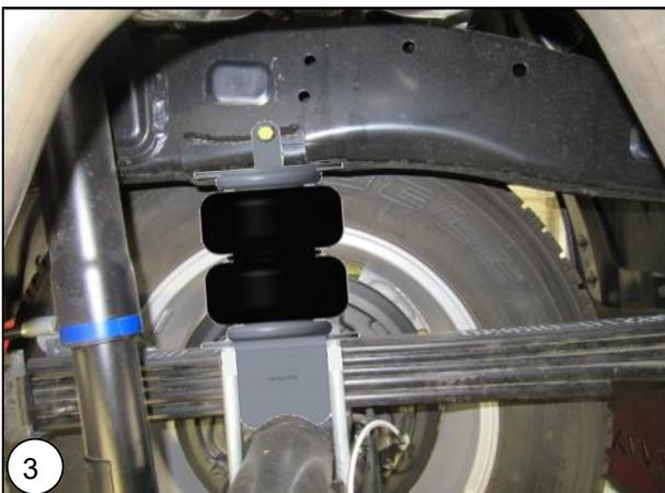
**NL** Plaats de luchtbalg compleet met beugels onder de veerstroppen. Zorg ervoor dat de luchtaansluiting naar binnen is gericht.
