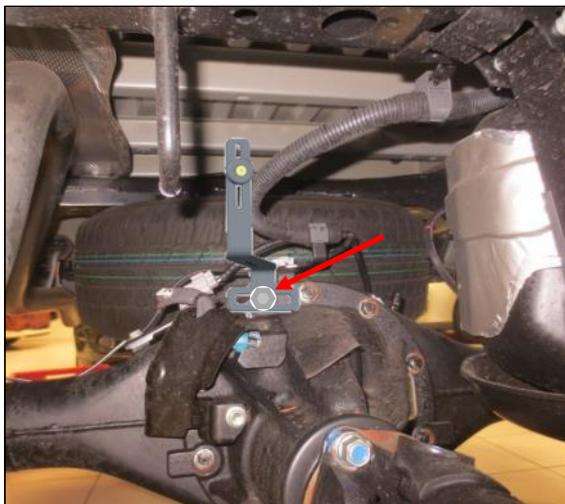
**NL** Monteer de magneetsteun op de achteras. Gebruik hiervoor de originele bout van het kabel bescherm schild.
