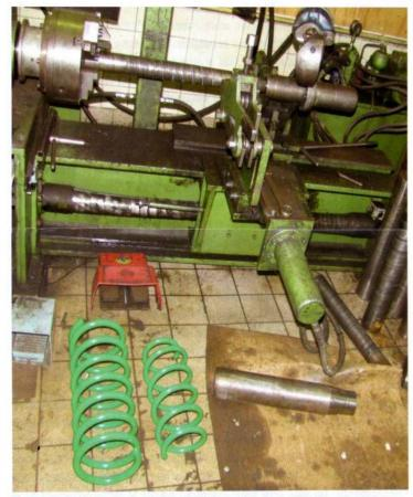
Notez que le ressort pour châssis X244 (à gauche sur la photo) est bien plus gros que celui des X 250. Ils sont tous réalisés dans une nuance d'acier bien spécifique au Chrome, silicium et vanadium de qualité supérieure aux matériaux d'origine de série donc au moindre coût de production...
