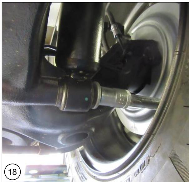
**NL** Zet de schokdempers vast met de originele bouten. Laat de auto nog **NIET** helemaal zakken. Hierdoor kan onherstelbare schade aan de luchtbalgen ontstaan.
