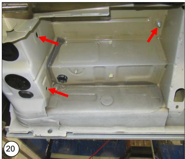
**NL** Locatie compressor: Voor de tank. Gebruik de originele bevestigingspunten, aangegeven in de afbeelding.
