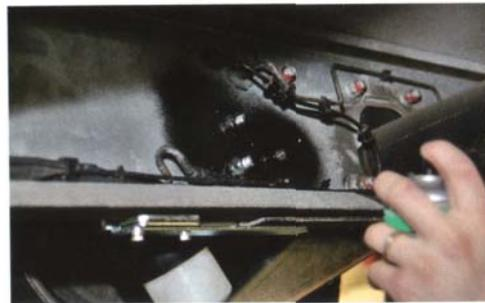
Sur les deux cotés, Jérémy pulvérise du blaxon au niveau des perçages puis des fixations pour éviter tout risque de corrosion ultérieure essentiellement due... au salage des routes en hiver !
