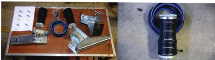
Voici donc le fameux kit de renforts pneumatique arrière dans sa version de base sans manomètres de pression ni compresseur. Tout est livré complet avec le circuit pneumatique, les valves, la visserie et les supports. Notez la compacité étonnante des coussins !
