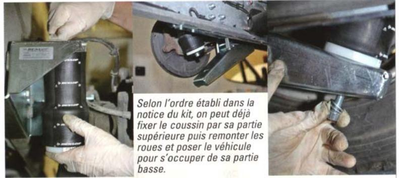
Selon l'ordre établi dans la notice du kit, on peut déjà fixer le coussin par sa partie supérieure puis remonter les roues et poser le véhicule pour s'occuper de sa partie basse.
