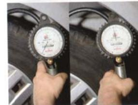
Voici l'effet des renforts pneumatiques des suspensions à 6,5 et 0,5 bars (valeur minimale). Nous avons pu observer un soulèvement à l'arrière du véhicule d'environ 17 cm à une pression de 6,5 bars. Le débattement est visiblement rétabli pour le plus grand bénéfice du confort et de la stabilité.
