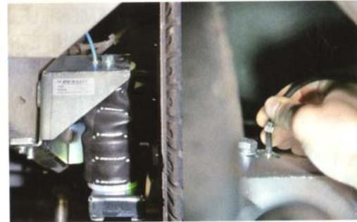
Passons au circuit pneumatique ! Un système bien particulier de montage permet une étanchéité absolue des tubes sur la sortie droite ou coudée du boudin à air. Les deux circuits indépendants droite et gauche sont acheminés et fixés sur le flanc gauche.
