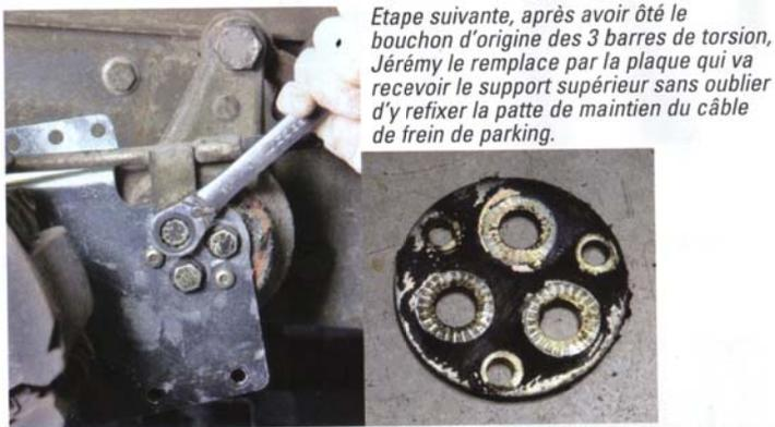
Etape suivante, après avoir ôté le bouchon d'origine des 3 barres de torsion, Jérémy le remplace par la plaque qui va recevoir le support supérieur sans oublier d'y refixer la patte de maintien du câble de frein de parking.
