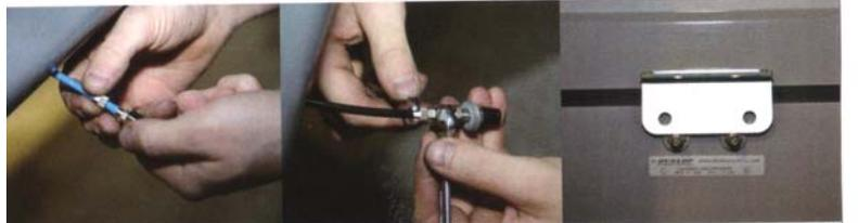
Gros plan sur l'une des 4 fameuses connections pneumatiques étanches à visser ici coté valve extérieure. L'ensemble est au final vissé à travers le bas de la cellule ou sur le support métallique fourni, en moins de temps qu'il n'en faut pour l'écrire !
