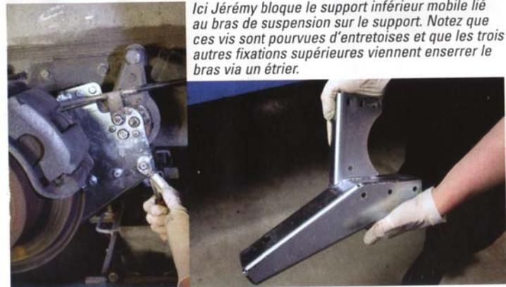
Ici Jérémy bloque le support inférieur mobile lié au bras de suspension sur le support. Notez que ces vis sont pourvues d'entretoises et que les trois autres fixations supérieures viennent enserrer le bras via un étrier.
