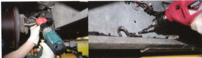
Dans ce robuste acier galvanisé, on doit effectuer des pré-perçages en diamètre 4 mm à l'aide d'un renvoi d'angle si nécessaire. Ensuite, de l'intérieur du châssis, on peut aisément amener au diamètre final les trois perçages repérés précédemment.
