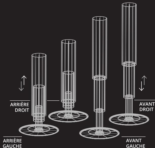
Vous pouvez actionner les vérins par paire **ARRIÈRE/AVANT | DROITE/GAUCHE** jusqu'à ce que le véhicule soit nivelé
