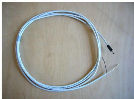
**Câblage équipé d'une prise pour les vérins afin de permettre la fonction frein à main supplémentaire.**
