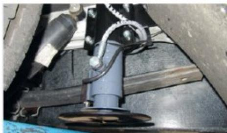
VÉRIN ARRIÈRE MONTÉ SUR X 250 À LAMES
