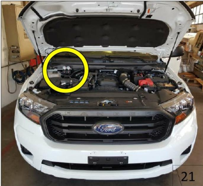
Positionnez le boîtier de contrôle de la pression à l'intérieur du compartiment moteur du véhicule comme indiqué sur les photos ci-dessus.
