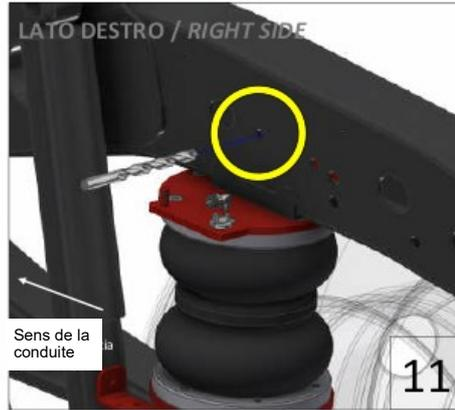
Agrandissez le trou intérieur sur toute l'épaisseur du châssis comme indiqué sur le schéma à l'aide d'une mèche de perçage Ø 8.5
