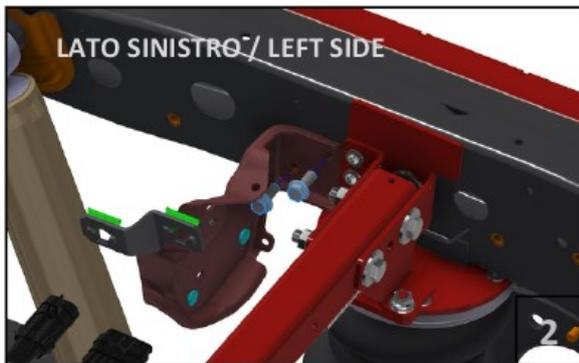
Dévissez le support des câbles et tuyaux de frein présent sur le côté gauche du véhicule.
