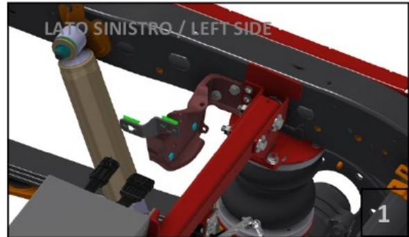
Il est nécessaire de repositionner le support des câbles et tuyaux de freinage sur le côté gauche du châssis.
