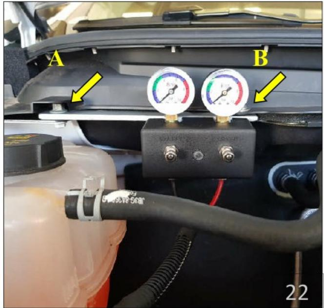
Sécurisez le support du boîtier de contrôle de pression sur le véhicule à l'aide d'une vis M6 à tête fraisée à visser à l'intérieur du compartiment moteur (A). Sécurisez l'autre côté (B) à l'aide d'une vis M6 à tête fraisée et un écrou en enlevant le clip plastique présent dans le trou.
