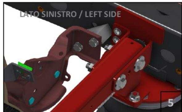
Vue de détail du support d'origine repositionnée correctement.
