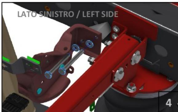
Utilisez les deux vis M8x65 et les rondelles coniques fournies dans le kit pour maintenir le support dans sa nouvelle position.
