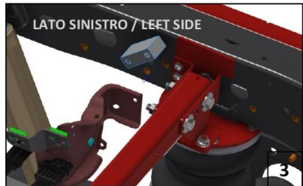
Placez l'entretoise fournie entre le châssis et le support d'origine comme indiqué sur le schéma.
