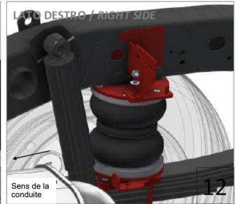
Repositionnez et fixez le support supérieur de la suspension que vous aviez démontée précédemment (Voir schéma 4) comme indiqué sur le schéma.
