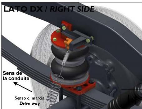
Utilisez l'entretoise fournie dans le kit pour compenser la distance entre le support et le châssis. Serrez les vis.
