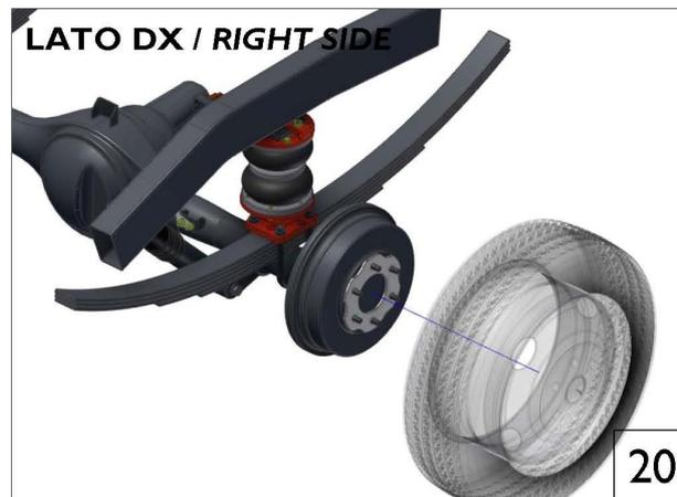
Vérifiez si la longueur des vis de roues est suffisante pour que la roue soit fixée correctement.
