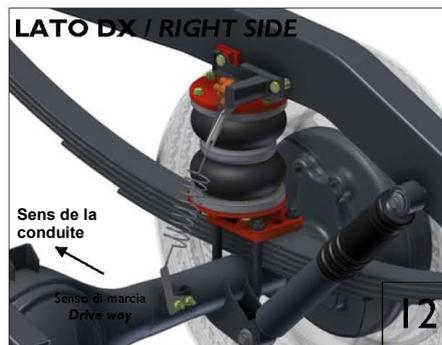
Vérifiez la connexion du ressort du régulateur de freinage avec la tige de réglage montée sur le pont du véhicule.
