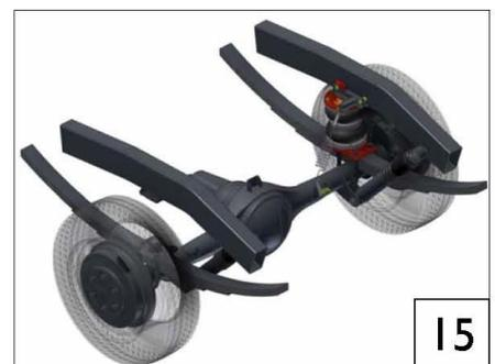
Suspension montée correctement. Répétez les opérations pour le côté opposé du véhicule. Notez que le régulateur de freinage n'est pas présent sur le côté gauche.
