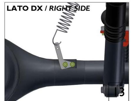
Détail de la tige du régulateur de freinage en position d'origine. Dévissez les écrous de blocage pour ajuster la position de la tige.
