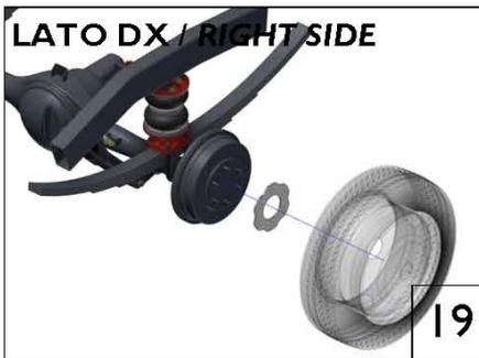
Placez l'élargisseur fourni dans le kit sur le tambour de frein à l'aide des boulons, entre le tambour et la jante.
