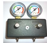
Boitier servant à limiter et à contrôler la pression d'air (1X)
