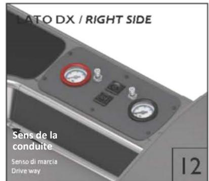
Connectez et installez le panneau de contrôle de gonflage sur le support porte-gobelets (percez le fond pour faire traverser les connexions de tuyaux d'air).
