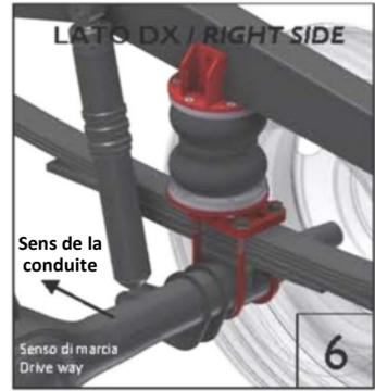
Placez les brides de fixation en U fournies dans le kit à la place des brides de fixation d'origine que vous avez démontées. Si nécessaire, coupez les extrémités.
