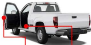
Placez l'étiquette d'indication de la pression à un emplacement visible pour le conducteur dans la cabine de conduite.
