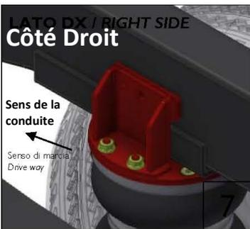
Détail du positionnement des supports de fixation. Positionnez les vis M8x100 dans les trous du châssis. Si nécessaire, percez un trou Ø9 dans le longeron en alignement par rapport au perçage existant sur le support de fixation fourni dans le kit.
