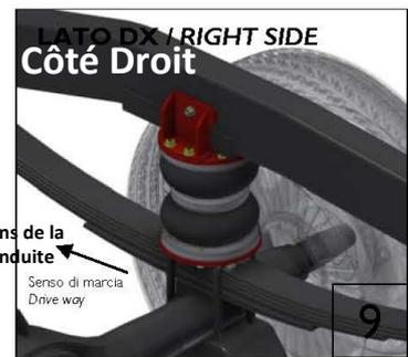
Suspension montée correctement. Répétez les opérations N° 1 à 8 sur le côté gauche du véhicule.
