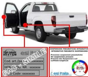
Placez l'étiquette d'indication de la pression à un emplacement visible pour le conducteur dans la cabine de conduite. Placez l'étiquette d'identification du kit dans le cadre de la porte du véhicule Côté Conducteur.
