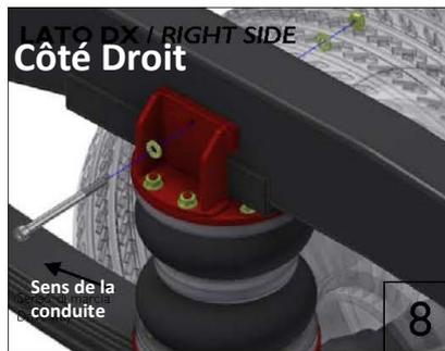
Insérez les vis M8 x 100 fournies dans le kit à travers le trou du châssis. Utilisez les écrous et rondelles pour le serrage. Serrez ensuite les écrous de fixation des supports sur le châssis.
