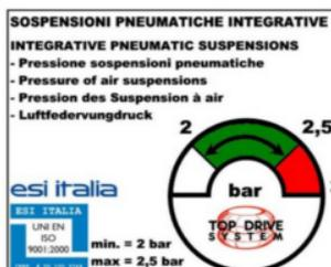
Placez l'étiquette de pression à un emplacement visible pour le conducteur depuis le poste de conduite.
