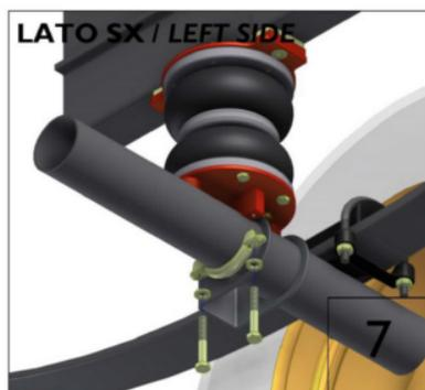
Fixez la suspension sur l'essieu à l'aide des brides fournies dans le kit, rondelles et vis M10.
