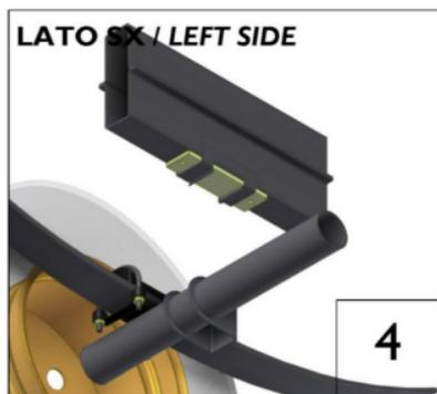
Positionnement correct de la plaque de fixation dans l'emplacement de la butée de choc.
