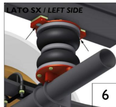
Fixez la suspension sur la support de fixation supérieur à l'aide des vis qui sont pré-installées.
