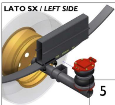
Positionnez la suspension entre l'essieu et le châssis.
