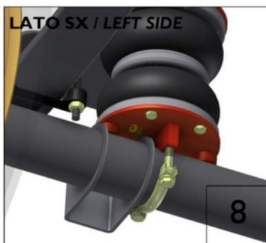
Insérez le tuyau Rilsan sur le raccord d'air sur le coussin.
