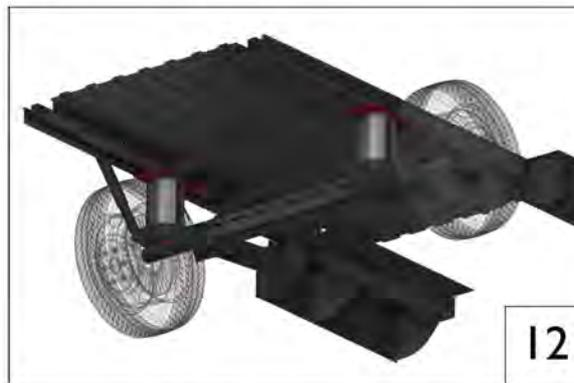
Fixez la partie inférieure de la fixation sur l'essieu à l'aide de la plaque inférieure fournie dans le kit et une vis M12x35 comme indiqué sur le schéma.
