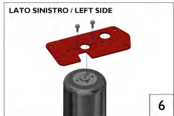
Installez la plaque support supérieure fournie dans le kit par-dessus le coussin comme indiqué sur le schéma, fixez-la à l'aide des deux vis à tête fraisée M8x30.
