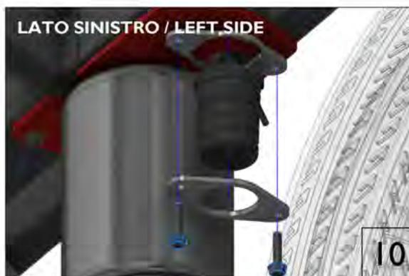
Installez la suspension sur le châssis dans la même position que celle de la plaque support d'origine démontée précédemment et fixez le côté arrière à l'aide des deux vis d'origine comme indiqué sur le schéma.
