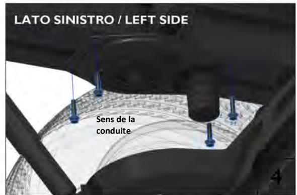
Démontez les ressorts d'origine de la plaque de fixation supérieure en dévissant les boulons de fixation.
