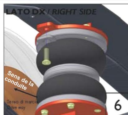
Fixez la suspension sur le trou Avant de l'emplacement où vous avez démonté la butée caoutchouc, utilisez la vis M10 et la plaque de blocage fournies dans le kit.
