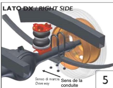
Positionnez la suspension entre le longeron du châssis et le pont par-dessus le paquet de lames.
