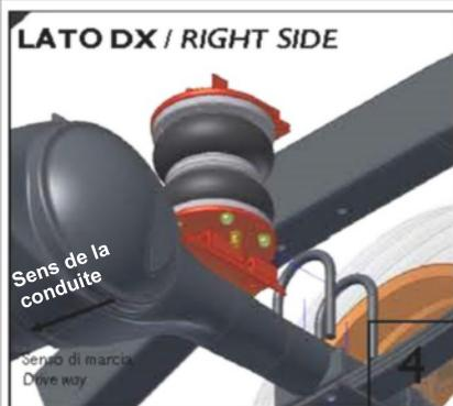
Insérez le tuyau RILSAN sur le raccord :
