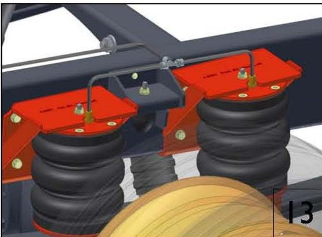
**Procédez maintenant à l'implantation du raccordement pneumatique sur l'avant et sur l'arrière de la suspension, du même côté du véhicule en les reliant avec le connecteur à 3-voies fourni dans le kit.**
