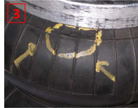
Déchirure et fuite d'air qui en découle, créées par friction entre la flasque et le flanc caoutchouc. Ce type de dommage est causé par une utilisation permanente du système avec une pression d'air insuffisante dans le système.
