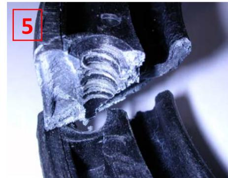
Flanc craquelé à cause d'une pression trop importante (Utilisation 10 fois à une pression supérieure à la pression normale). Ceci est provoqué par une pression excessive de gonflage des coussins et / ou par une surcharge au-delà de la limite autorisée par le constructeur du véhicule.
