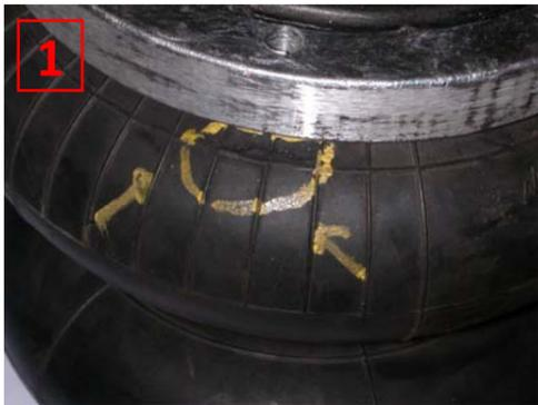
Coussin endommagé à cause d'un frottement contre le flanc caoutchouc. Ce dommage se produit si on utilise continuellement trop peu de pression dans les coussins, ce qui provoque un frottement entre la flasque plastique ou aluminium et le caoutchouc.
