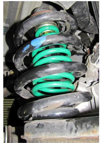
Après le montage : Le véhicule est soulevé de + 30 / + 40 mm
