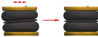
Déport axial si le coussin n'est pas aligné sur les supports
