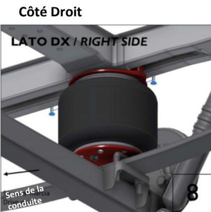
Fixez la suspension sur la plaque supérieure à l'aide des vis M8. Serrez les vis dans les taquets de fixation.
