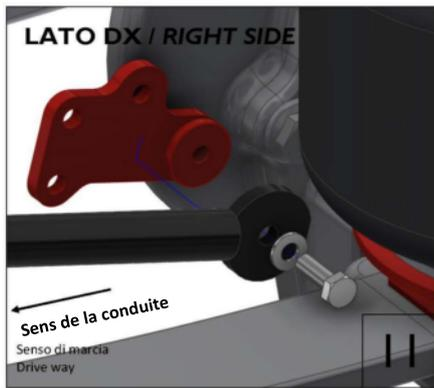
Placez le support d'adaptation sur la barre stabilisatrice comme indiqué sur le schéma et fixez-la à l'aide d'une vis M10x30 et une rondelle.
