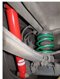
Pour tous les autres véhicules qui n'ont pas de lames de ressort à l'arrière, **CARSUPPORT** propose une large gamme de ressorts renforcés pour l'arrière |
