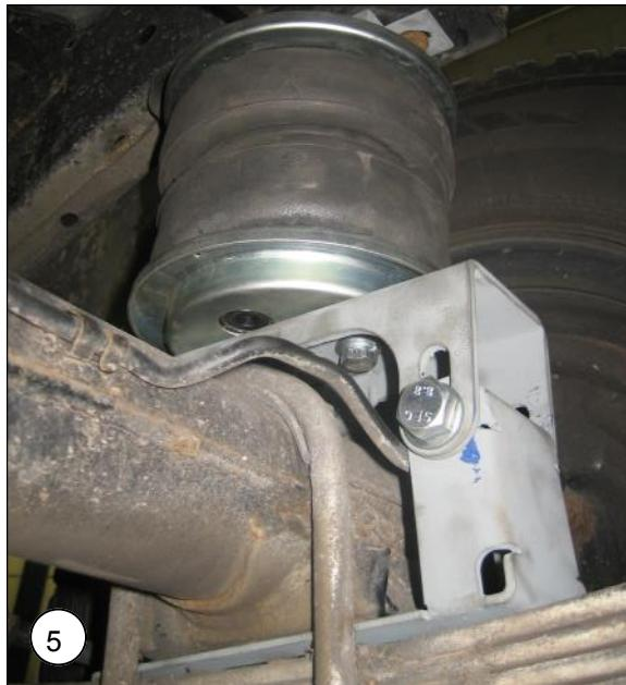
**NL** Plaats de luchtbalg compleet met de boven- en onderbeugel tussen het chassis en de as.
