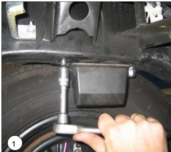
**NL** Verwijder beide aanslagrubbers van het chassis.
