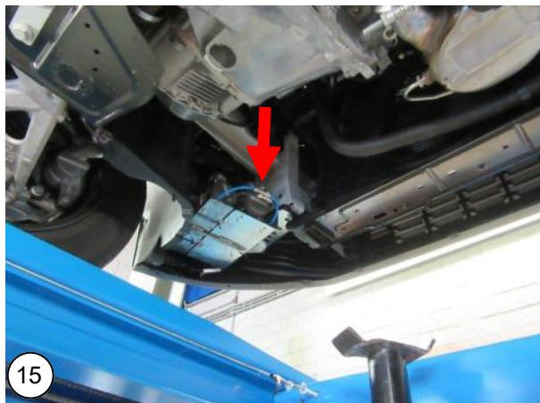
**NL** Sluit de luchtslangen aan op de fittingen van de compressorbak. Sluit de blauwe slang aan op fitting **R** en de zwarte slang op fitting **L**.
