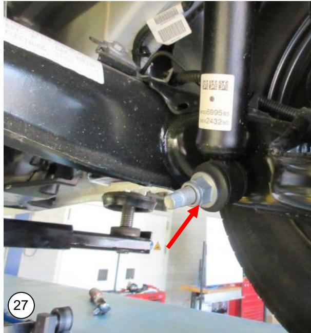
**NL** Zet de schokdempers vast met de originele bouten. Laat de auto nog **NIET** helemaal zakken. Hierdoor kan onherstelbare schade aan de luchtbalgen ontstaan.
