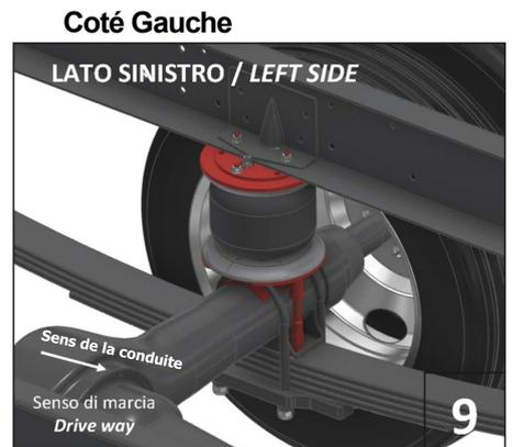
Installation terminée. Procédez de la même façon sur le côté droit du véhicule en suivant les instructions des schémas 2 à 8. Gonflez les deux suspensions et vérifiez qu'il n'y a aucune fuite d'air sur le circuit.
