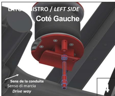
Placez la tige anti-rotation et l'écrou de blocage sur la douille filetée de la partie inférieure de la suspension.
