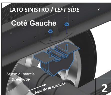
Démontez les deux butées caoutchouc des 2 côtés en dévissant les deux écrous à l'intérieur du châssis. Puis rendez-les au propriétaire du véhicule.
