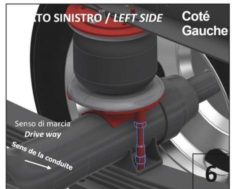
La tige anti-rotation inférieure doit être placée à l'intérieur de la plaque support des lames de ressort comme indiqué sur le schéma afin d'éviter la rotation. Ajustez la hauteur et fixez la tige à l'aide de l'écrou.
