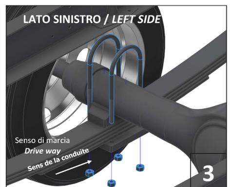
Enlevez temporairement les brides en U qui maintiennent l'empilage des lames de ressort afin de faciliter l'installation de la suspension en dévissant les écrous inférieurs.
