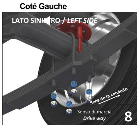
Remontez les brides en U et fixez la partie inférieure de la suspension comme indiqué sur le schéma. Fixez le paquet de lames de ressort en serrant les écrous inférieurs d'origine et les écrous auto-bloquants.
