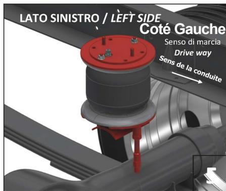
Placez la suspension près de l'essieu et fixez les tuyaux Rilsan sur les raccords métalliques :
