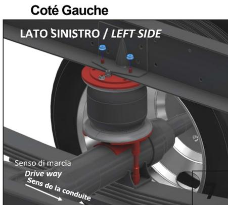
Placez la suspension sous le châssis et positionnez les tiges filetées dans les trous laissés vacants lors du démontage des butées de choc. Fixez la suspension à l'aide de deux écrous à tête fraisée M8.
