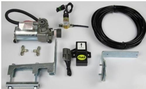
**CS** = Kit pour véhicules à lames de ressort livré avec 2 coussins à 2 étages Ø 16,5 cm, supports de fixation et visserie, Kit compresseur et Panneau de Commande Spécifique selon le type de véhicule
