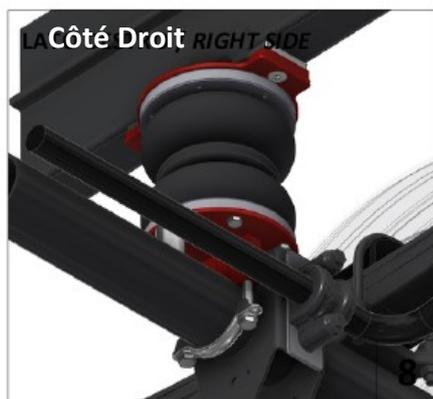
Vue de détail : vérifiez bien que tous les tuyaux hydrauliques et câbles électriques d'origine du véhicule ne frottent pas contre des obstacles.
