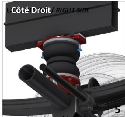
Fixez la suspension sur le support de fixation supérieur à l'aide des vis qui sont pré-installées.
