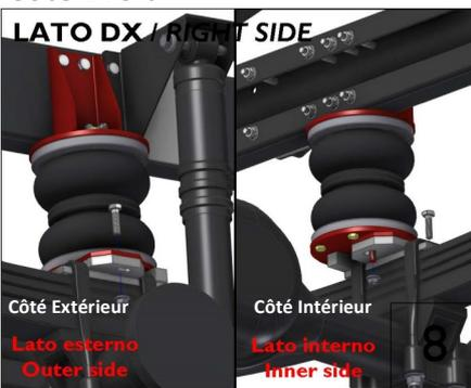
Fixez la suspension sur la plaque de fixation inférieure à l'aide des vis M10 et écrous fournis dans le kit comme indiqué sur le schéma (Côté Extérieur et Côté Intérieur).
