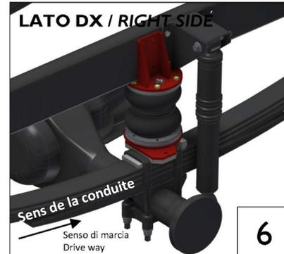
Placez la suspension sur le support inférieur et alignez le support supérieur dans les trous laissés vacants par le démontage de la butée de choc.
