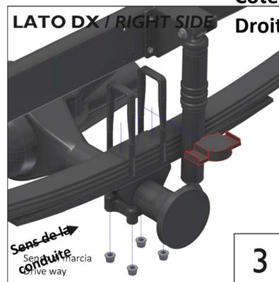
Dévissez les brides de fixation, enlevez les plaques de fixation d'origine des lames de ressort et ensuite rendez-les au propriétaire du véhicule.
