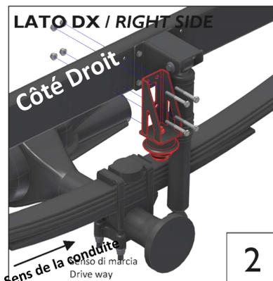
Enlevez les butées de choc d'origine en dévissant les 4 boulons comme indiqué sur le schéma et rendez-les au propriétaire du véhicule.
