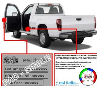
Placez l'étiquette de pression à un emplacement visible pour le conducteur depuis le poste de conduite.
