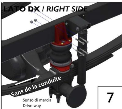
Fixez la suspension sur le châssis à l'aide des vis et écrous d'origine que vous aviez démontés en enlevant la butée de choc d'origine.
