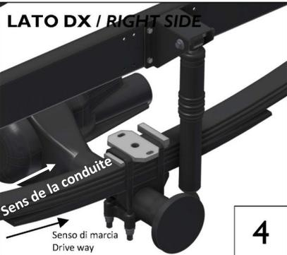
Positionnez la plaque de fixation fournie dans le kit sur les lames de ressort et revissez les brides de fixation sur les lames de ressort.
