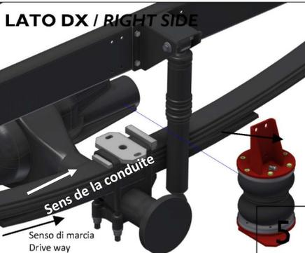
Avant de positionner la suspension, insérez le tuyau Rilsan sur le raccord d'air sur le coussin.
