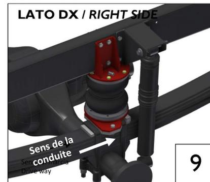
Suspension montée correctement. **Répétez les opérations de 1 à 8 sur le côté GAUGHE du véhicule.**
