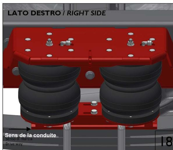
Connectez les suspensions au circuit pneumatique en raccordant les tuyaux Rilsan sur les raccords d'air :
