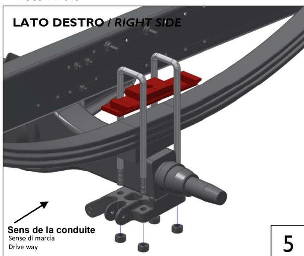
Placez la plaque support de la suspension à la place du support d'origine que vous avez démonté et fixez-le à l'aide des nouvelles brides de fixation en U fournies dans le kit.
