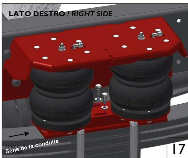
Fixez la plaque inférieure sur le support de fixation inférieur à l'aide des vis M8x20 et les rondelles.
