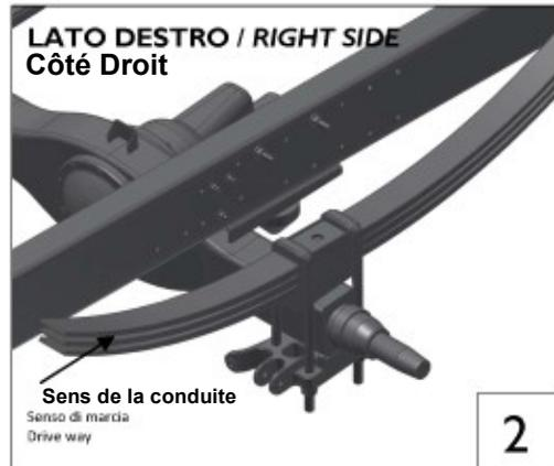
Pour faciliter le montage des suspensions pneumatiques, il est conseillé de démonter les roues du véhicule.
