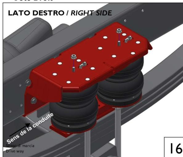
Assurez-vous que les raccords des tuyaux d'air et les vis supérieures de fixation sont parfaitement placées et alignées par rapport aux trous du support du châssis comme indiqué sur le schéma. Fixez les suspensions à l'aide des écrous M8.
