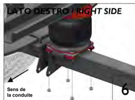
Le montage du kit est facilité si vous placez les raccords de tuyaux d'air tournés vers l'intérieur du véhicule.
