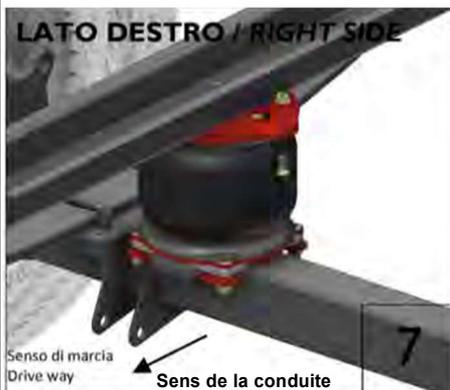
Fixez la suspension sur le support supérieur à l'aide des vis M8 fournies dans le kit.
