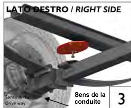
Positionnez la plaque de fixation supérieure sous le longeron du châssis et fixez-la à l'aide d'une vis M10 dans le trou que vous avez libéré en enlevant la butée de choc.
