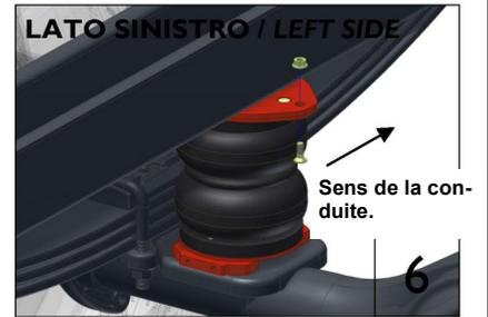
Fixez la suspension sur le support supérieur à l'aide des vis M8, écrous et rondelles fournis dans le kit.
