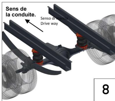
Suspension montée correctement. Répétez les opérations de 2 à 8 sur l'autre côté du véhicule et gonflez le système à la pression correcte.
