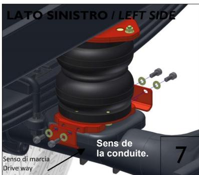
Fixez la partie inférieure de la suspension sur la plaque fixée sur le pont comme indiqué sur le schéma, à l'aide des supports de fixation, boulons et rondelles fournis dans le kit.
