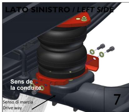
Fixez la partie inférieure de la suspension sur la plaque fixée sur le pont comme indiqué sur le schéma, à l'aide des supports de fixation, plaques de blocage, boulons et rondelles fournis dans le kit.
