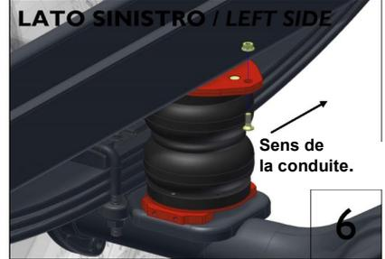
Fixez la suspension sur le support supérieur à l'aide des vis coniques M8 et écrous fournis dans le kit.
