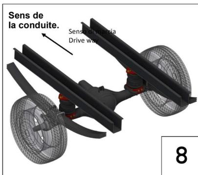
Suspension montée correctement. Répétez les opérations de 2 à 8 sur l'autre côté du véhicule et gonflez le système à la pression correcte.
