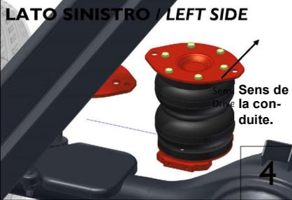
Avant de fixer l'assemblage de la suspension, placez d'abord le tuyau d'air sur le raccord :
