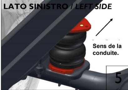
Placez la suspension sur le support sur l'essieu arrière et sous le longeron comme indiqué sur le schéma.
