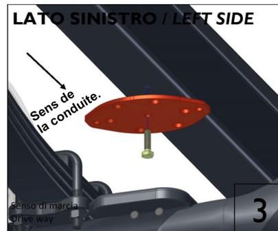
Positionnez la plaque de fixation supérieure sous le longeron à l'emplacement de la butée de choc d'origine et fixez-la avec la vis M10 fournie dans le kit.
