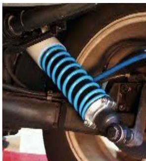
**5** = Ressorts renforcés auxiliaires arrière. Se montent à l'intérieur des ressorts d'origine.
