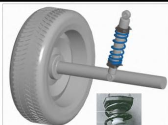
**7** = Ressorts renforcés arrière auxiliaires montés sur l'amortisseur en complément du ressort d'origine.
