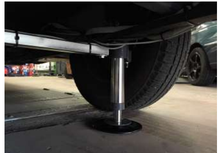
Vérin arrière X250 monté sur châssis AL-KO avec une barre transversale
