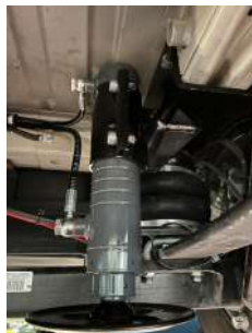
Vérin arrière X250 monté à l'intérieur du châssis
