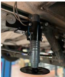
Vérin arrière X250 monté à l'extérieur du châssis
