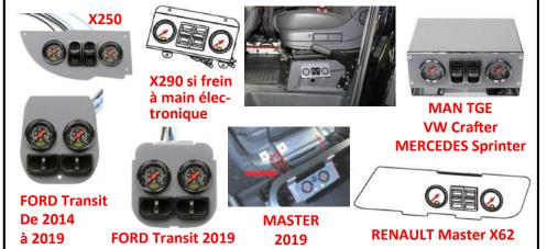
C = Kit livré avec 2 coussins à 2 étages Ø 17 cm, supports de fixation et visserie, Kit compresseur et Panneau de Commande Format DIN-1 Auto-Radio avec deux Boutons à 2 positions Haut et Bas pour gonfler et dégonfler Droite et Gauche séparément.
