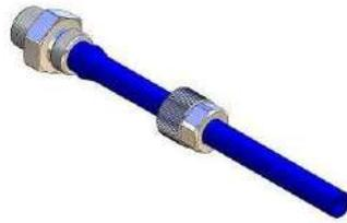
B. Poussez le tuyau sur le raccord le plus loin possible.
