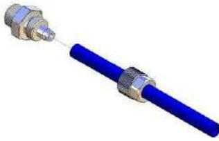
A. Faites glisser un petit écrou par-dessus une extrémité du tuyau.
