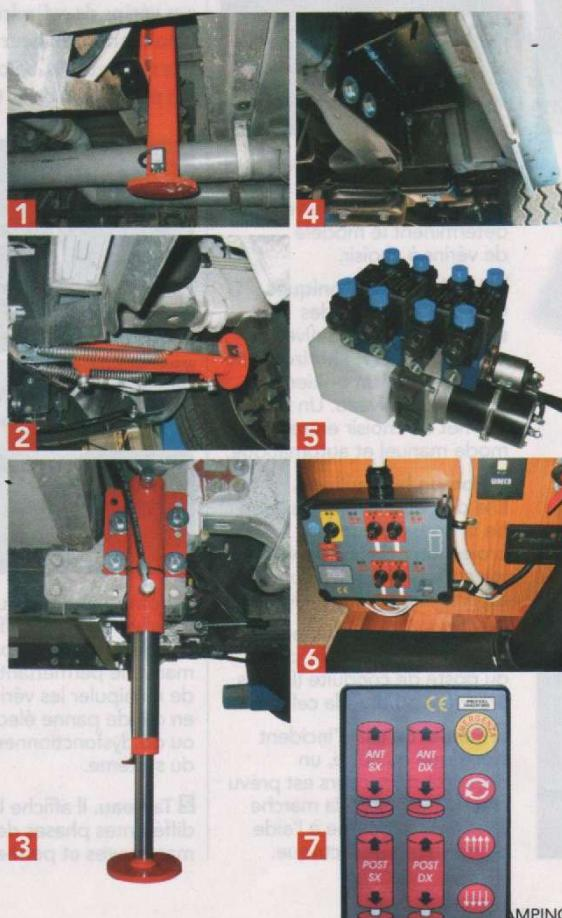
**1 Vérins verticaux.** Ils peuvent être installés sur des véhicules dont le châssis d'origine bénéficie d'espaces suffisants pour les loger.
