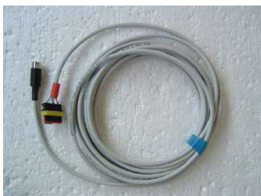
Câbles de liaison des capteurs
