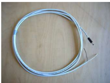
Câblage équipé d'une prise pour les vérins afin de permettre la fonction frein à main additionnelle.
