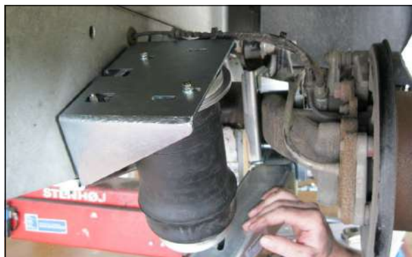
Photo d'un coussin en cours de montage châssis FIAT AL-KO
