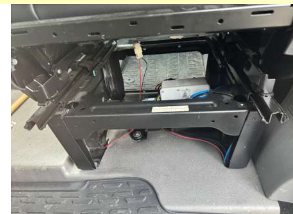
Montage du compresseur sous le siège conducteur.
